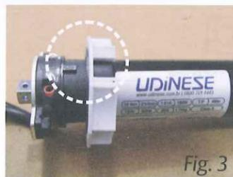
2) No final do encaixe, alinhe o rebaixo da coroa com a guia do corpo do motor, encaixe até que encoste as costas da coroa no ressalto do motor, conforme figura 3;
