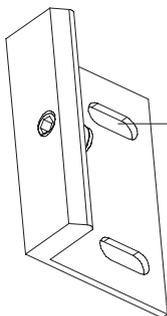
**Rasgos da cantoneira:** utilizando a cantoneira como gabarito e um lápis, faça duas marcas na parede a uma distância de 35 mm a partir do limite da janela até o centro dos furos de fixação.
