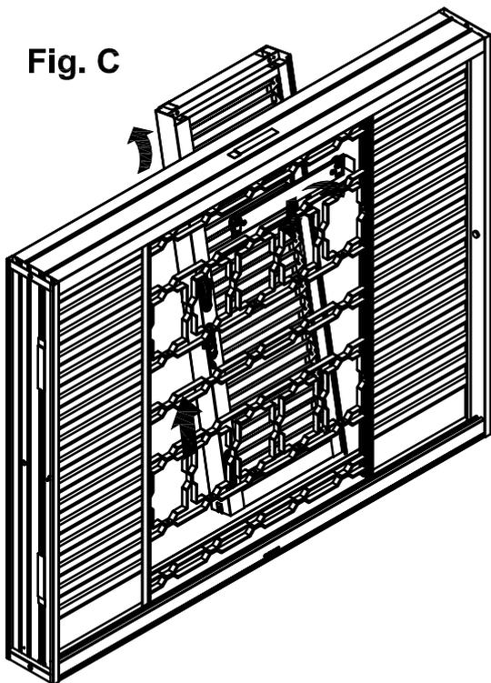
7- Com as folhas venezianas fechadas, retirar os parafusos que fixam o suporte do rodízio usando uma chave de fenda philips, conforme Det.3.
