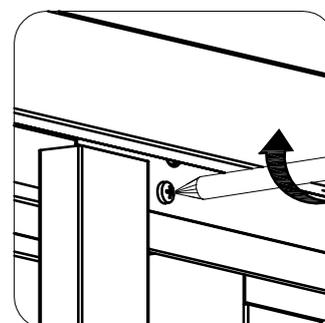
18- Colocar o suporte do rodízio da folha de vidro, inclinando-o para o lado interno e encaixando-o no trilho (Det.13).
