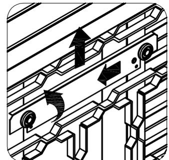
4- Retirar a folha de vidro direita movimentando-a para cima e inclinando-a para trás (Fig. B).
