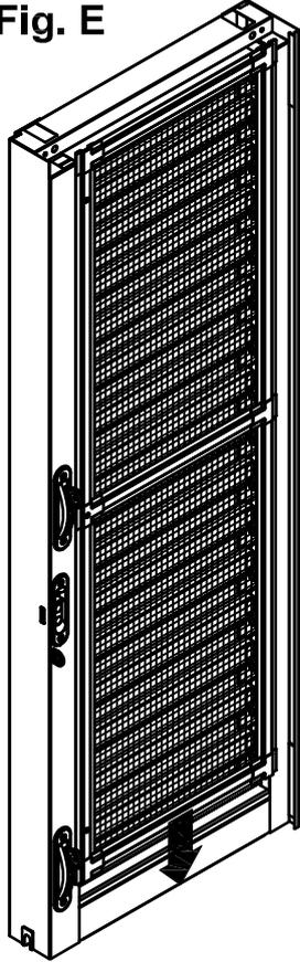
**12-** Encaixar as presilhas de sustentação na aba da moldura inferior (Fig. E).
